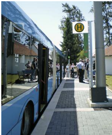
Bild 2: Warum ist der niveaugleiche Zugang nicht auch bei der 1. Tür?
